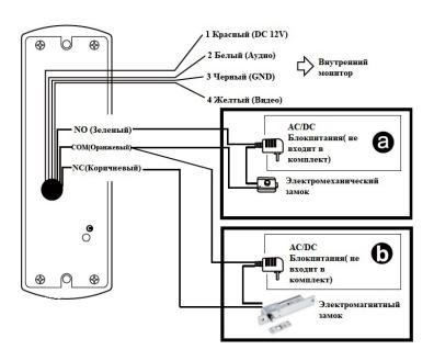
**ПРИМЕЧАНИЕ:** данная панель имеет возможность подключения как электромеханического замка с контактами (N.O), так и возможность подключения электромагнитного замка с контактами (N.C).
